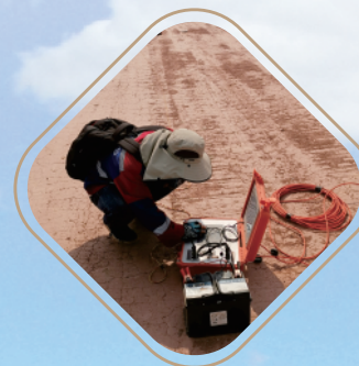
刚果(金)马本德尾矿库坝体物探无损监测
